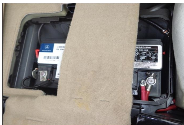
接正极 在副驾驶位找到我们要接的正极电，用我们的红色线接正极电源(箭头)
