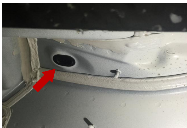
左踏板电机穿线孔：车底对应孔位(箭头)在孔周边打防水胶，然后把胶塞穿进线内把空封好防止进水。 左右两边踏板电机穿线孔方法一致；
