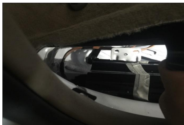
左踏板电机穿线孔：车内室穿线孔位置；把线从此处孔穿过；
