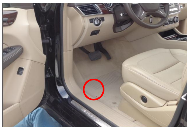
左踏板电机穿线孔：把驾驶室座位的脚垫掀开(箭头)，看到我们要穿线的孔，孔位与安装支架的螺栓孔共用；左右两边穿线孔一致；
