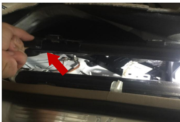
左踏板电机穿线孔：掀开此处垫脚海绵看到孔；
